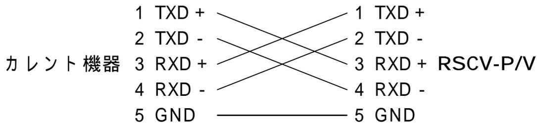
ご注意 5番の GND は、アース接地状態、GNDレベルの電位差等を考慮に入れ、システムの状況に応じて結線してください。
