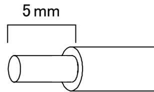
ケーブルの被覆は、5mm 剥いてネジ止めします。尚、撚線の場合、剥いた部分の半田付けは、端子台には適しません。
